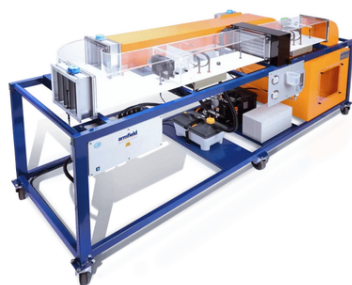
UNITÀ DI ARIA CONDIZIONATA A RICIRCOLO CONTROLLATA DA COMPUTER
